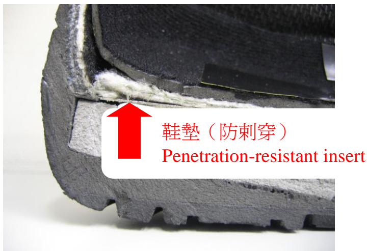
圖二：防刺穿鞋墊提供防刺穿能力
