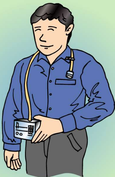
工人配帶 空氣抽樣儀器
